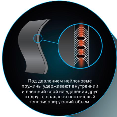
Под давлением нейлоновые пружины удерживают внутренний и внешний слой на удалении друг от друга, создавая постоянный теплоизолирующий объем.
